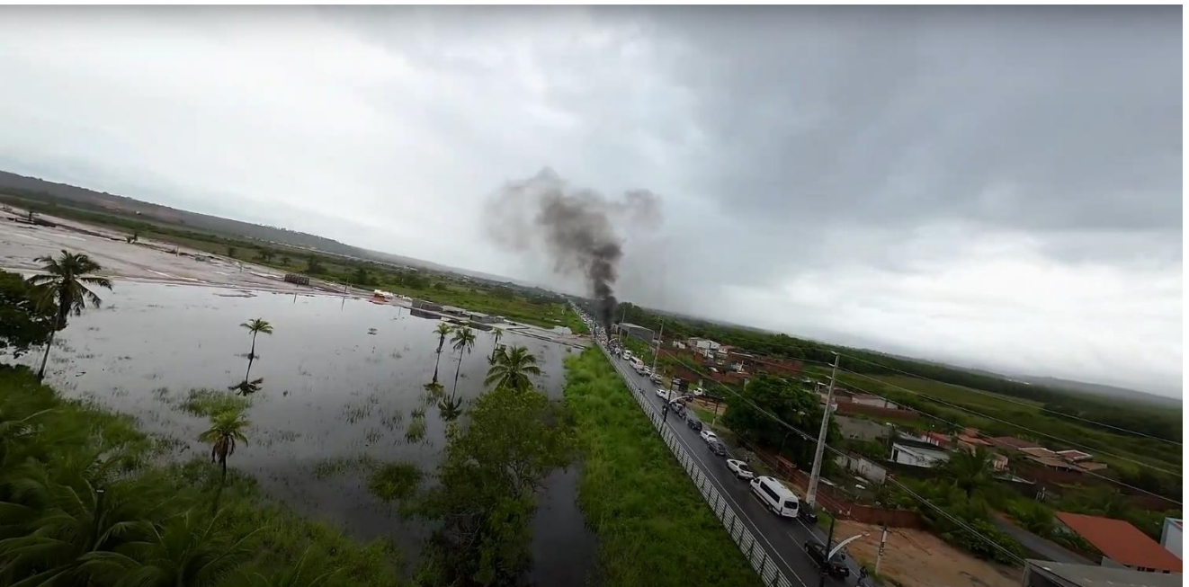
Marechal Deodoro/AL: na foto dá para ver o aterro em areia em um terreno que está sendo aterrado, E o terreno ao lado com água represada, sem ter o devido escoamento. (maio, 2024).
