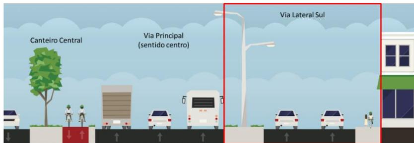
Figura 6: Seção esquemática da Via Lateral Sul
