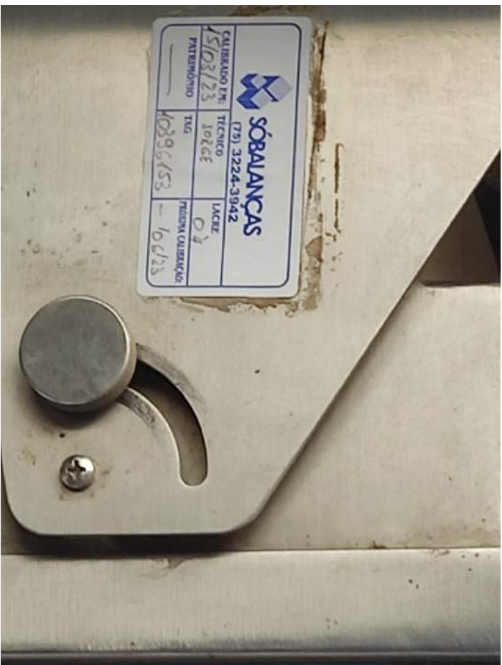
Imagem 16. Registro de calibração das balanças na CTRM 1/2.
