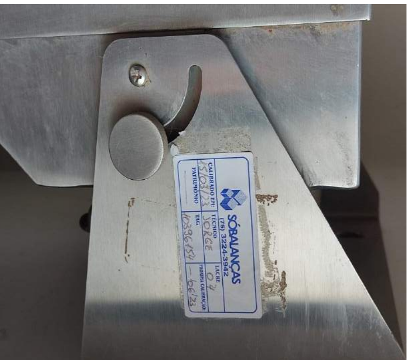
Imagem 17. Registro de calibração das balanças na CTRM 2/2.
